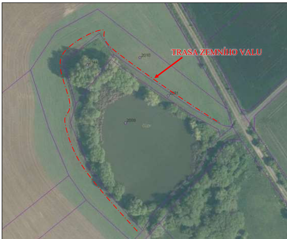
Obr. 25 Rybník Rosinec – ochrana proti splachu půdy (podklad ortofoto ČÚZK)
